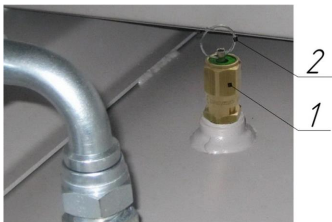
Рисунок 9 – Клапан предохранительный пружинного типа
